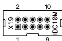
Коммуникационный порт предназначен для соединения с другим компьютером либо с коммуникационным оборудованием (например, с модемом). Нумерация разъема идет от квадратной площадки.
