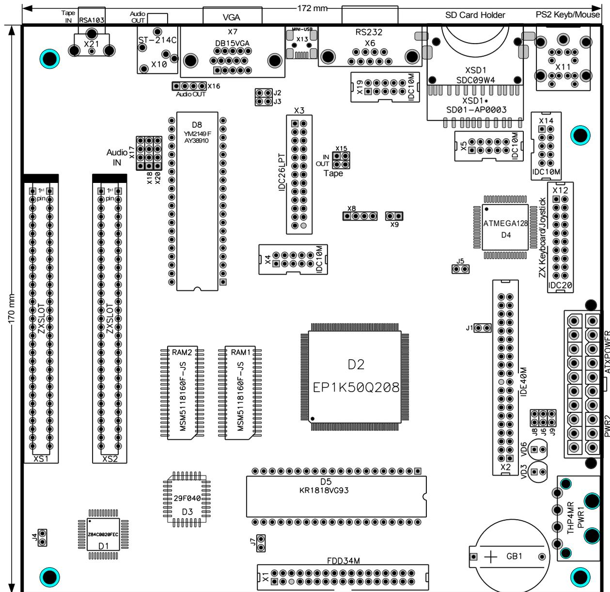
Плата оснащена отверстиями для крепления в корпус miniITX согласно спецификации<sup>1</sup>. Также основные рабочие разъемы для подсоединения периферии расположены в «окне» ATX корпуса, что облегчает установку платы и доступ к разъемам.
